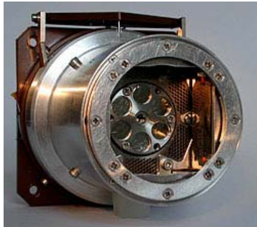
Abbildung 2: Sensorkopf des Alpha-Röntgen-Spektrometers
