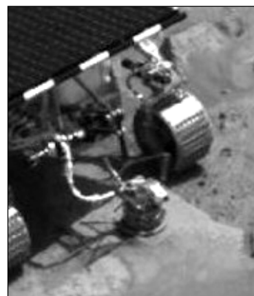
Fig. 3: APXS auf Marsboden für eine Messung.
