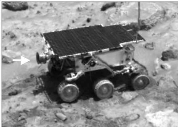
Fig. 1: Rover Sojourner unterwegs auf der Mars-Oberfläche. Links das APXS (Pfeil).
